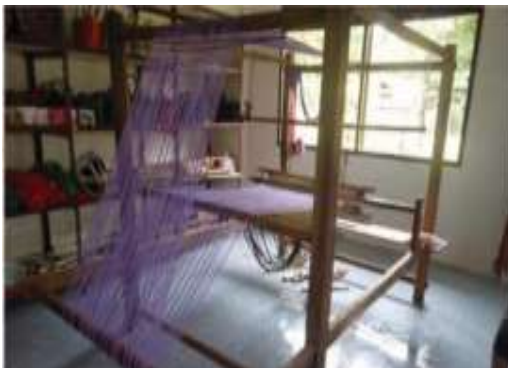
รูปภาพ แสดงการขึ้นหูกทอสาขิด ลายตะขอสลับเอื้อ
