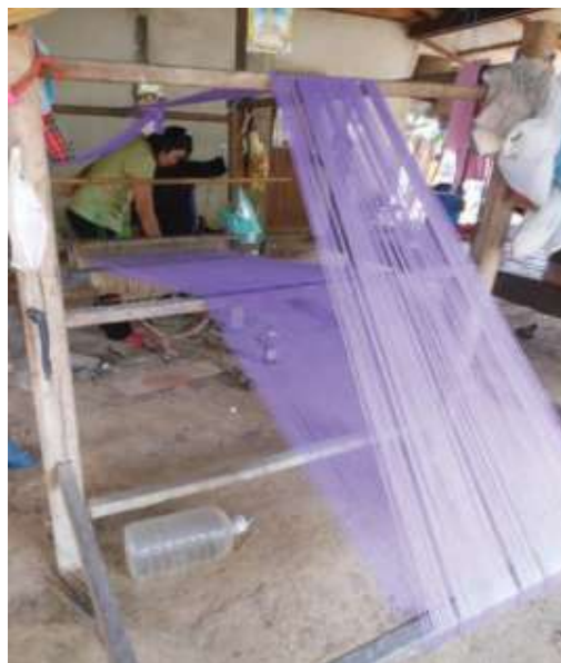
รูปภาพ แสดงการขึ้นหูกทอสาขิด ลายตะขอสลับเอื้อ
